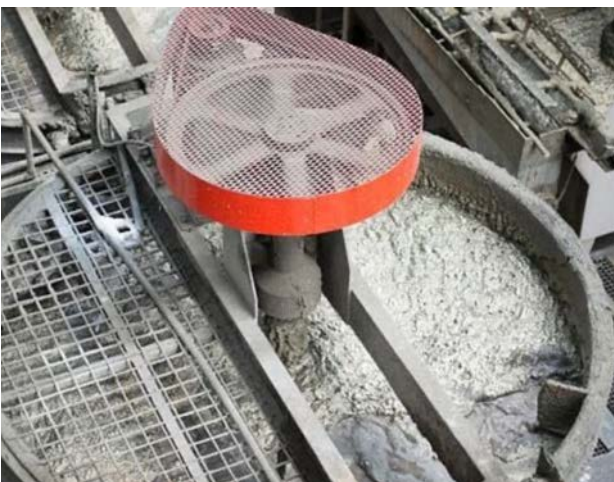
Celda de flotación
